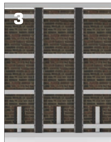
3. Połącz ramki ze sobą płytami „cieniowymi”. Przy podłodze i suficie zamocuj płyty maskujące.
