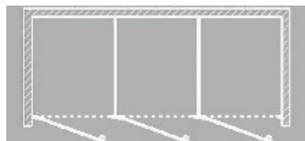
I - montowane pomiędzy ściany
