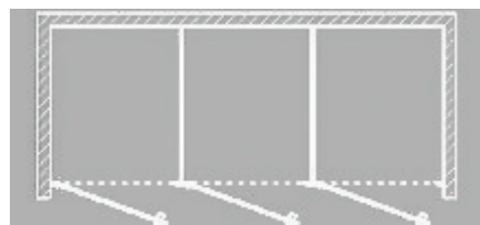
I - montowane pomiędzy ściany
